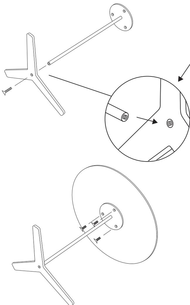
Verbindungsrohr mit Fuss verschrauben. Benutzen Sie dazu die lange Schraube.
