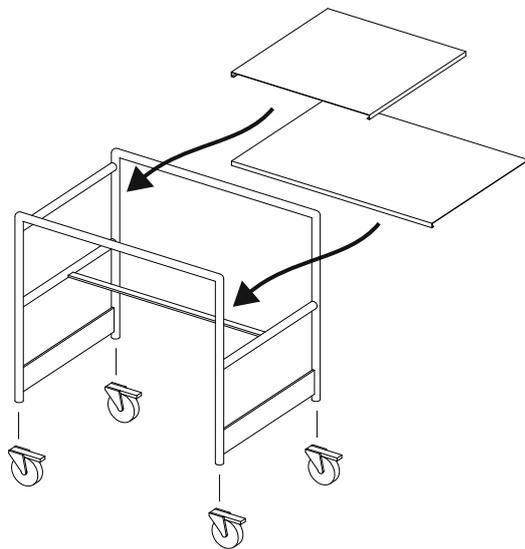
Das Verbindungsset mit den Löchern im Seitenrahmen auf mittlerer Höhe verschrauben.
