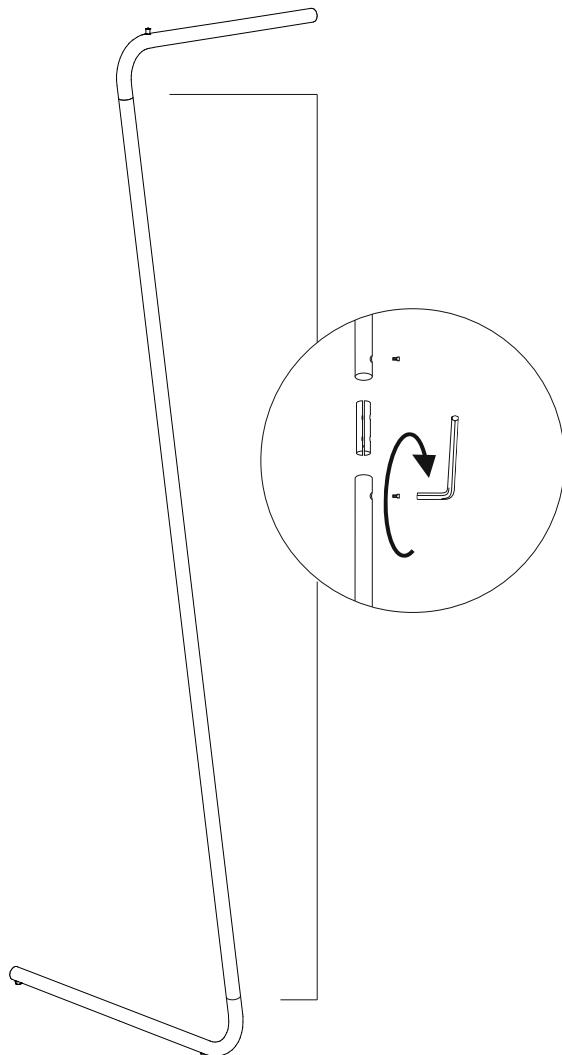
Das Querrohr Unten und das Standrohr auf den Boden legen und mittels Rohrverbbindern verschrauben.
