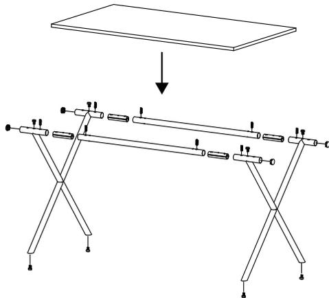
Die zwei Kreuzfüsse mittels Rohrverbinder mit den Zargen zusammen stecken.
