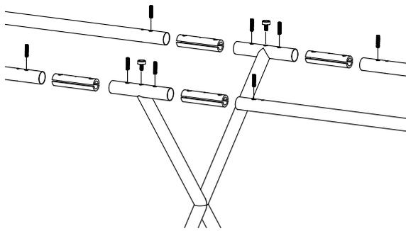
Zwei Rohrabschlüsse entfernen und die Rohrverbinder mit den Zargen und dem Kreuzfuss zusammen stecken.
